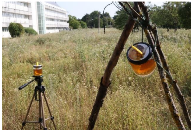
Abbildung 4: Locktöpfe auf offener Fläche mit guter Weitsicht aufgestellt. Vorderer Locktopf: hängende Vorrichtung mit zusammengebundenen Stecken. Hinterer Locktopf: gekauftes Stativ. © AGES/Schorkopf
